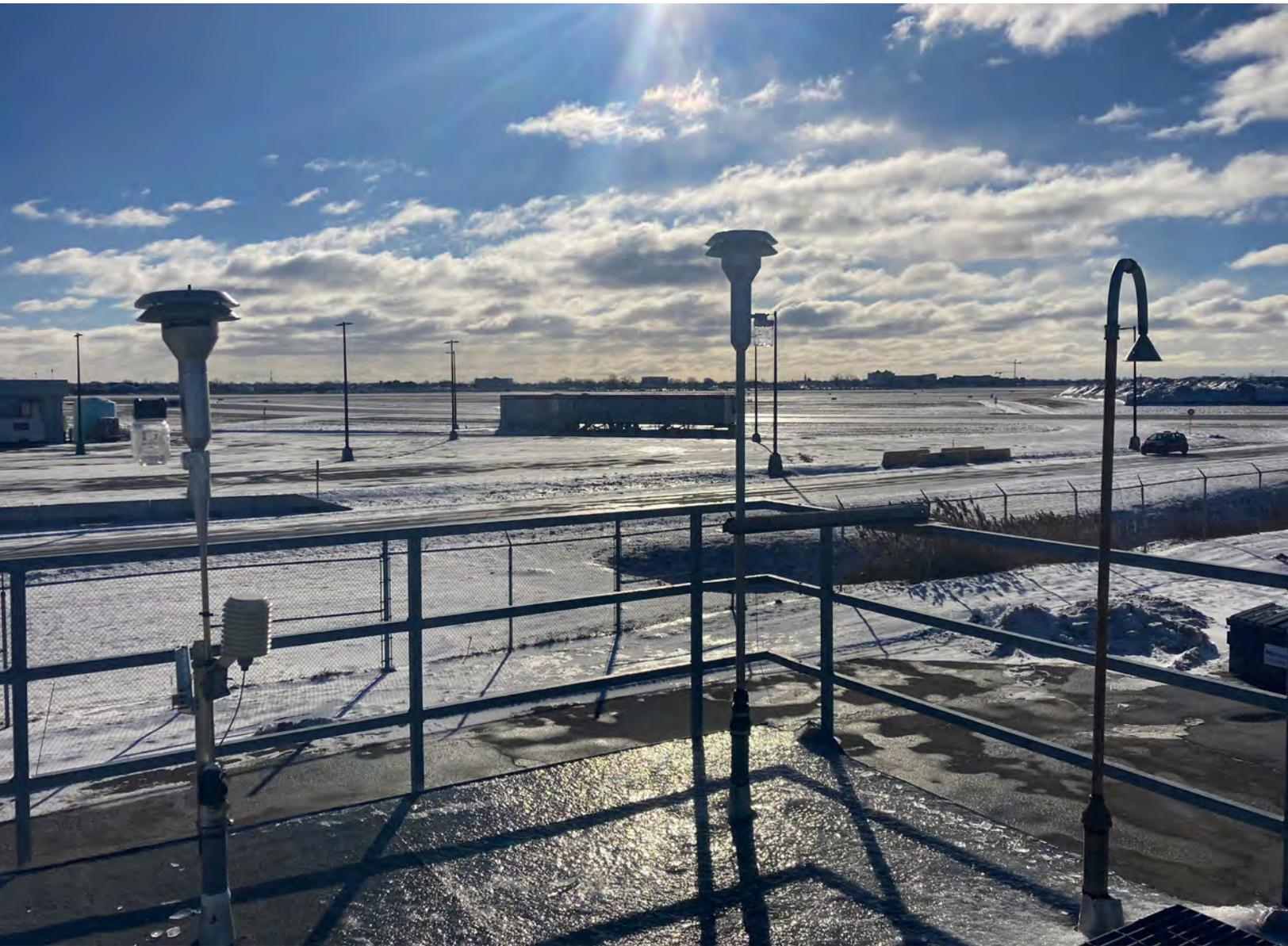
Depuis octobre 2020, un analyseur de particules ultrafines (PUF) installé à la station 55 (12400, rue Wilfrid-Ouellette, Rivière-des-Prairies-Pointe-aux-Trembles) permet d'évaluer les concentrations en milieu résidentiel influencé par le chauffage au bois. La moyenne annuelle de particules ultrafines à cette station en 2022 était de 7552 particules/cm<sup>3</sup> alors qu'elle était de 7629 particules/cm<sup>3</sup> en 2021, ce qui représente une très légère diminution de 1%.
